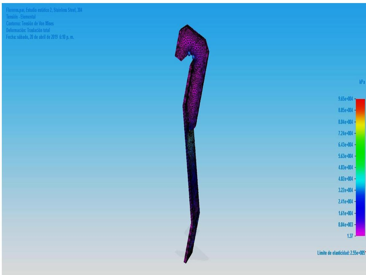
Figura 71. Solid edge 3D. Von mises soporte tanque interno. Autoría propia.
