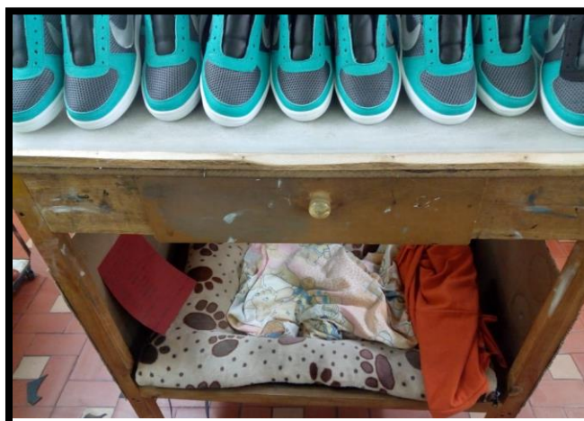
Figura 69. Tarjeta roja en área de solado por objetos que no pertenecen a esta área
