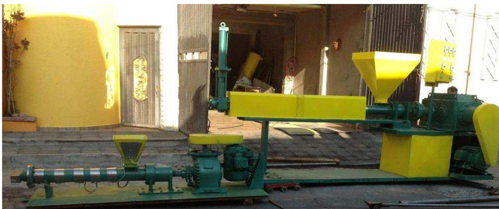
**Figura 40.** Peletizadora 50MM x 1.500MM. Dinaplast.
