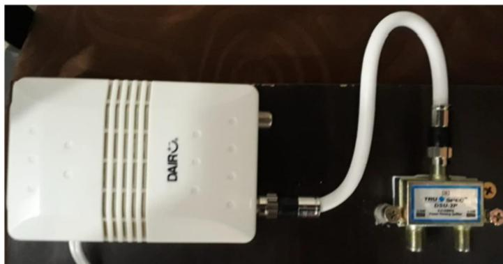
2. Instalar un cable coaxial en cada salida del distribuidor A, conectando cada cable en la entrada del distribuidor B y C respectivamente.
