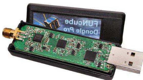
Figura 27. Funcube Dongle (AMSAT-UK, 2011)
