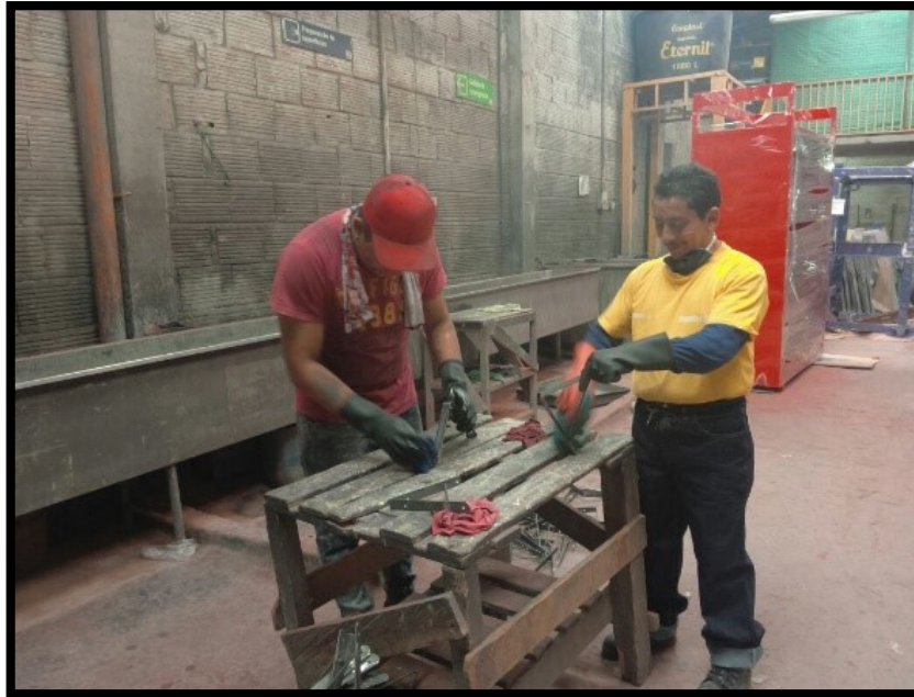
Ilustración 11 Secado de Piezas con Trapo
