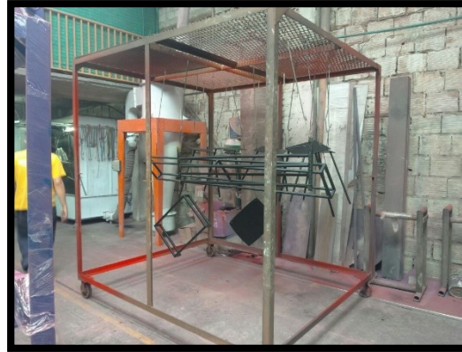
Ilustración 19 Carro utilizado para colgar las piezas e introducirlas al horno 2.
