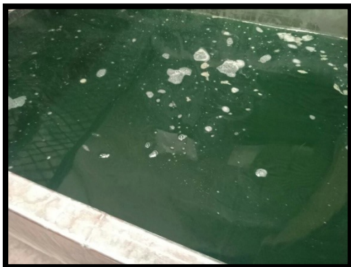
Ilustración 29 Agua con fosfato y desengrasantes del tanque n° 03
