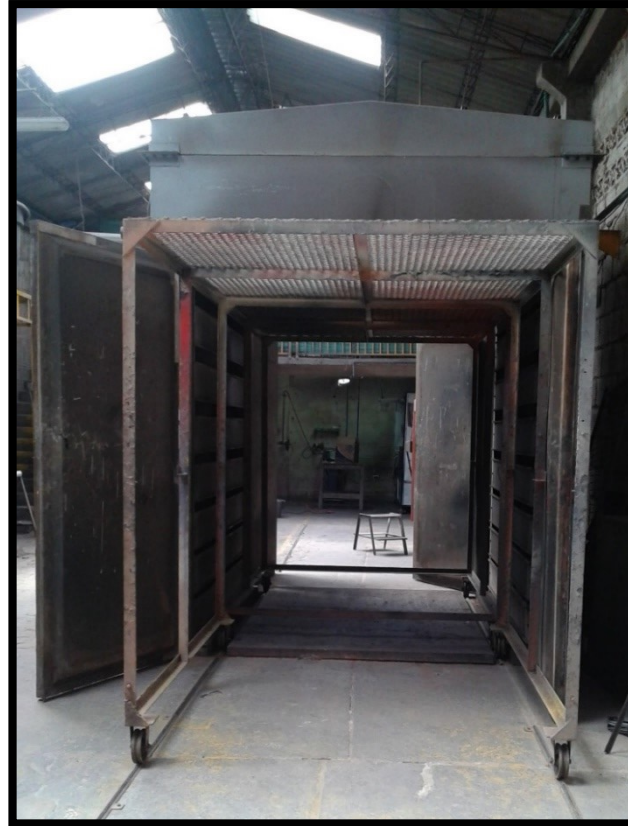
Ilustración 7 Horno que se utiliza para el proceso de pre horneado de piezas.
