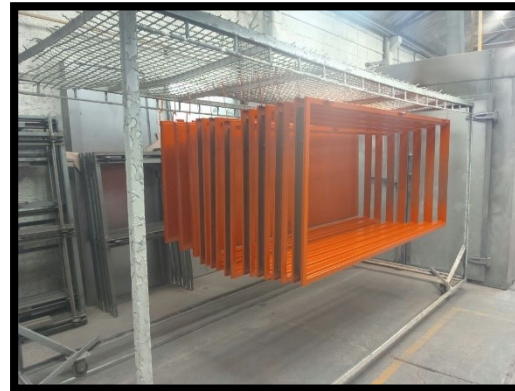
Ilustración 20 Carro utilizado para colgar las piezas e introducirlas al horno 1.
