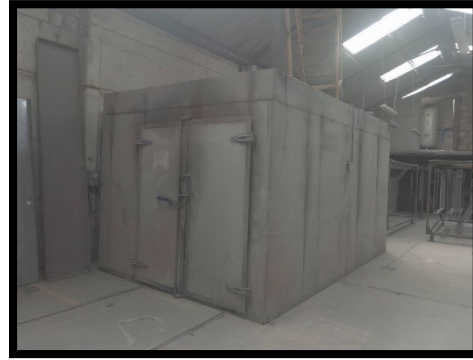
Ilustración 17 Horno 1 utilizado para el Proceso de Polimerizado.
