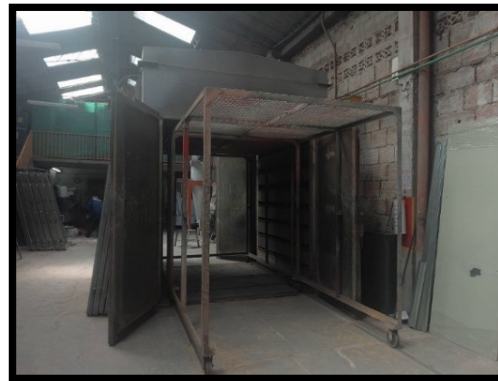
Ilustración 18 Horno 2 utilizado para el Proceso de Polimerizado.
