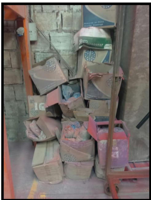
Ilustración 26 Acumulación de Pintura Contaminada.
