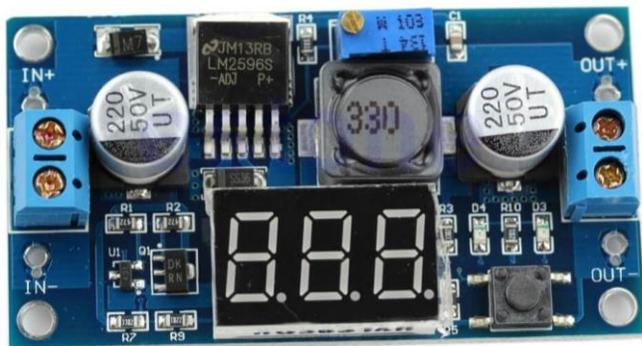
**Figura 24.** Regulador de Voltaje – LM2596. Sacado de Electronilab (s.f.)
