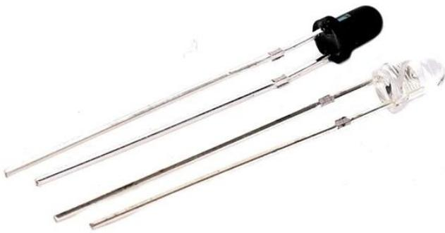
**Figura 21.** Sensor de presencia – Leds Infrarrojos. Sacado de JABots (s.f.)
