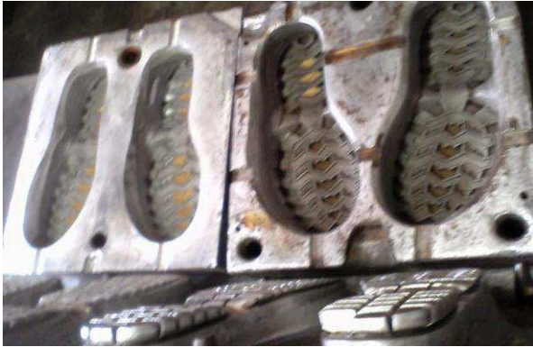
Figura 22. Moldes para suelas.
