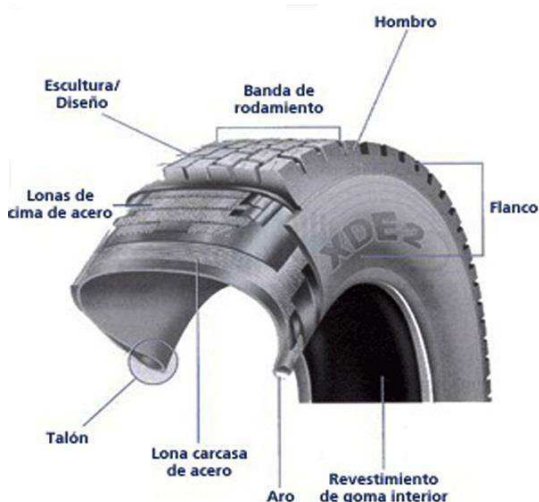
Figura 3. Partes de la llanta.
