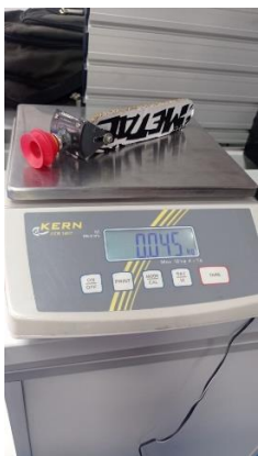
Figura 22. Peso de la muñeca y gripper. Elaboración propia (2022).
