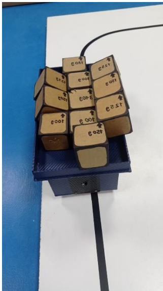
Figura 24. Carga máxima sin sobre esfuerzo. Elaboración propia (2022).
