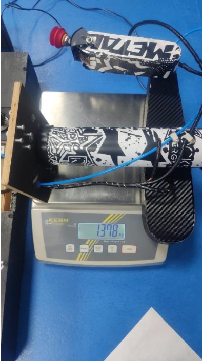
Figura 23. Peso en gramos del brazo robótico. Elaboración propia (2022).
