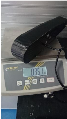
Figura 20. Peso del hombro y brazo junto con un contrapeso de 220g. Elaboración propia (2022).
