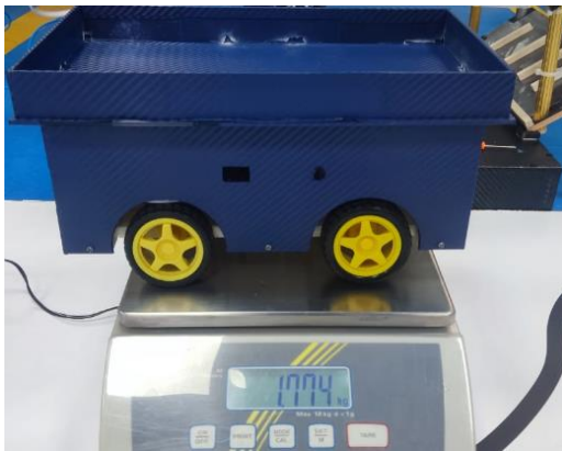
Figura 26. Peso de la estructura del robot AGV. Elaboración propia (2022).
