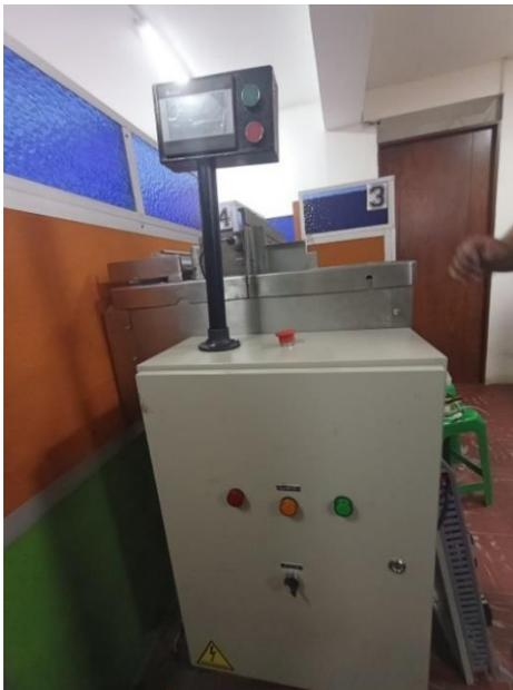
**Figura 52.** Caja tablero de control con HMI (Elaboración propia).
