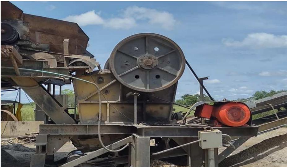
**Figura 10.** Trituradora de mandíbulas. Propia (2022).
