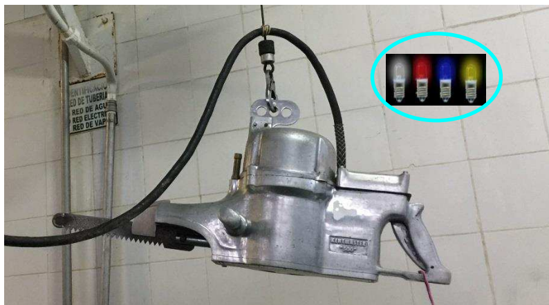
Figura 26. Fotografía sierra de pecho con montaje de método ANDON. Nota: Autoría propia
