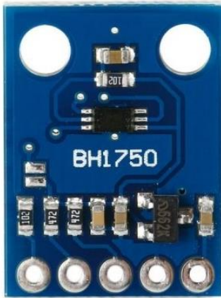
Figura 8. Sensor luz luminosidad BH750 (Naylamp, SF)
