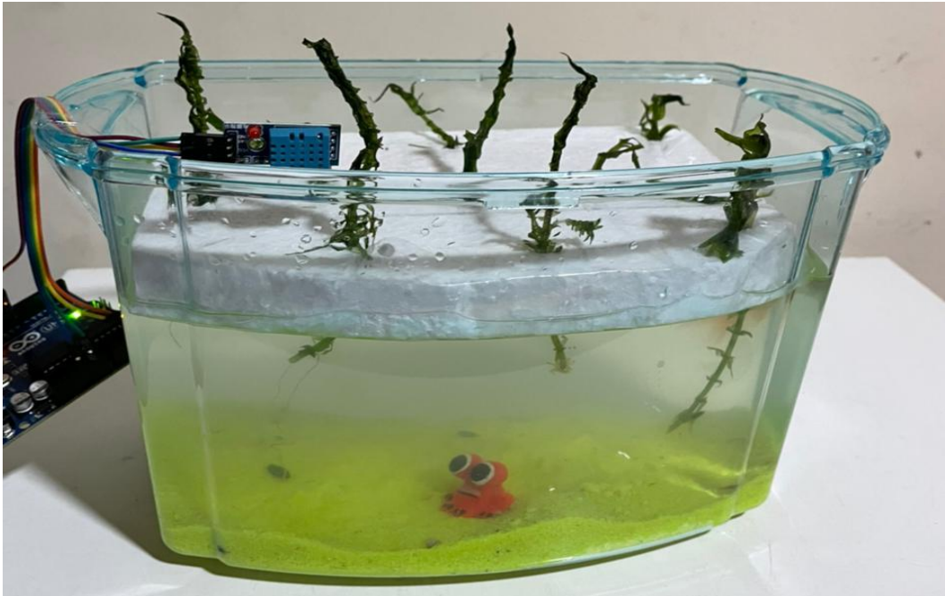
Figura 19. Sensor humedad y temperatura ambiente dentro de la pecera (Autoria Propia, 2021)
