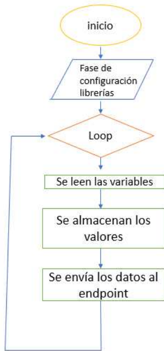
Figura 12. diagrama de flujo que describe la lógica de recolección de datos (Autoria Propia, 2021)
