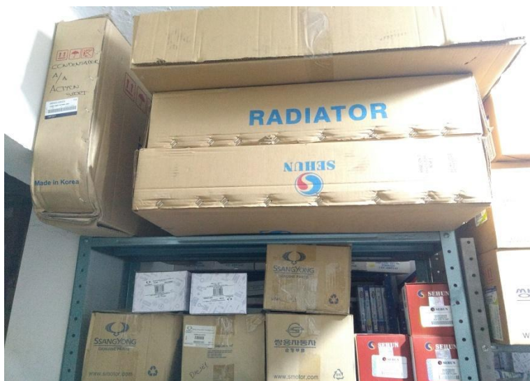
Figura 33. Peligro de caída de mercancía. Elaboración propia.
