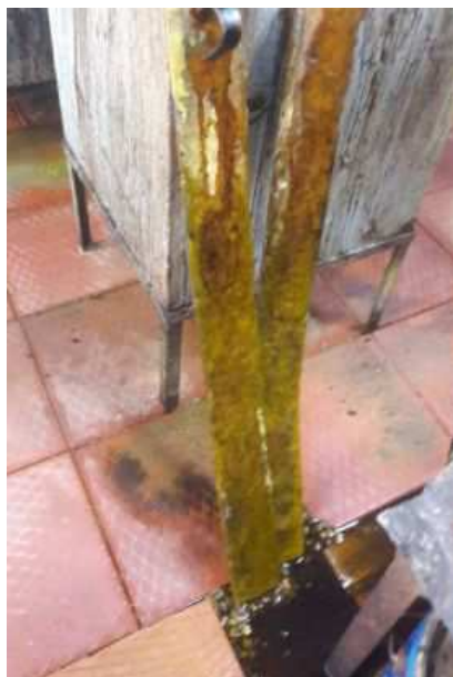
Figura 44. Pesos para tanque de mordentado.
