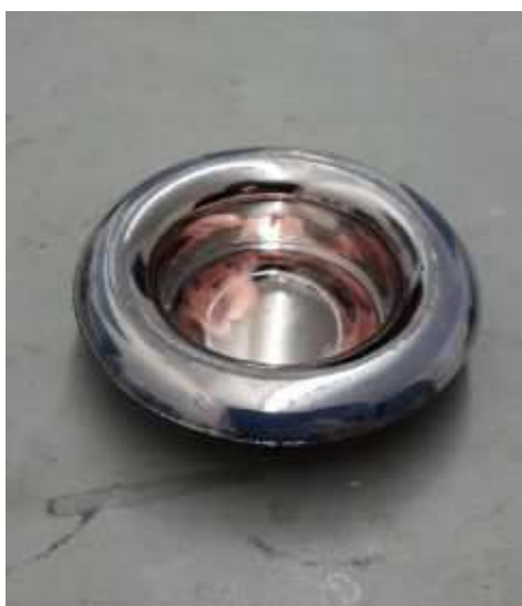
Figura 57. Cacerola con defectos en cavidad.
