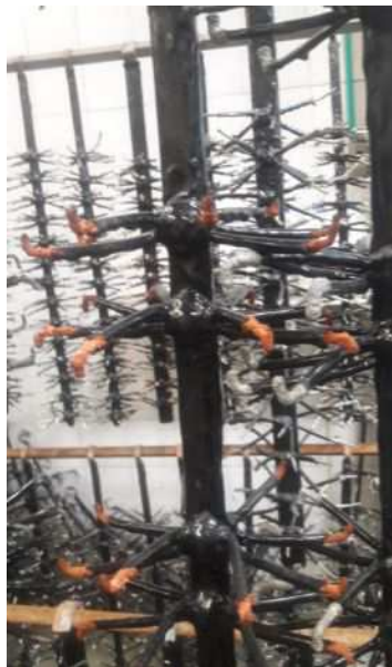
Figura 59. Gancheras con Poka Yoke.
