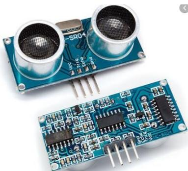
**Figura 5.** Sensor de proximidad. Tomado proyectoarduino.com (2020)
