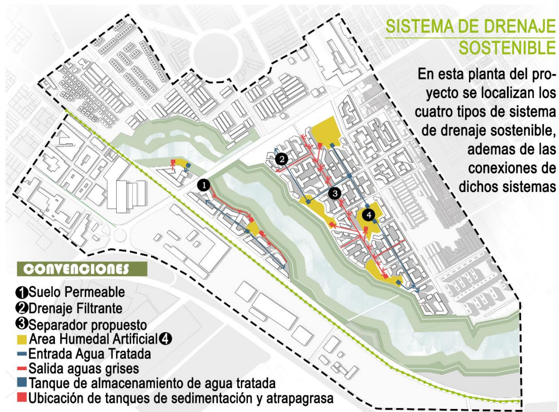
Figura 100. Planta Sistema de Drenaje Sostenible. Autoría propia (2019)
