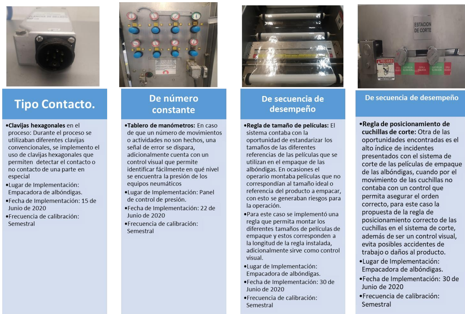
Figura 27. Implementación de dispositivos a prueba de error (Poka Yoke). Autoría propia.
