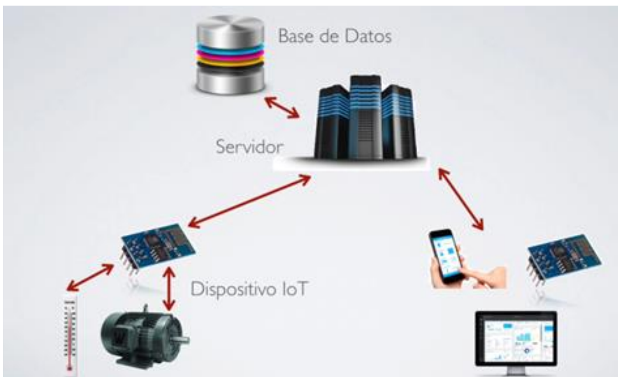
Figura 7 Componentes de una red IoT. Fuente Ioticos 2016
