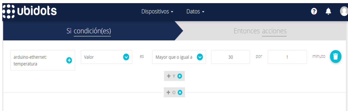
Figura 47 Evento temperatura ambiente alta. Autoría propia. (2020)
