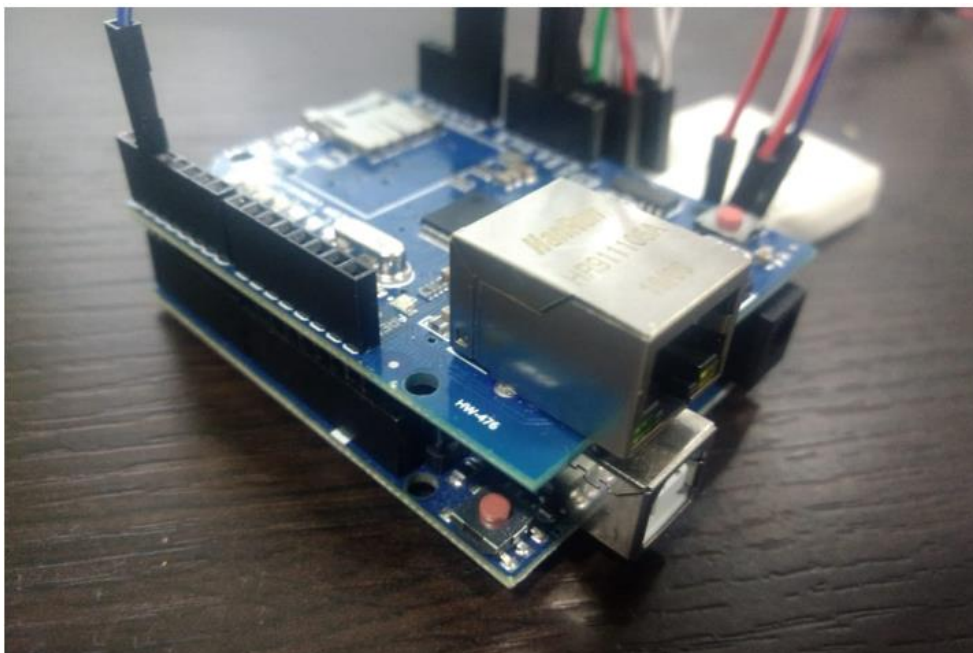
Figura 14 Conexión del Shield Ethernet al Arduino. Autoría propia (2019)
