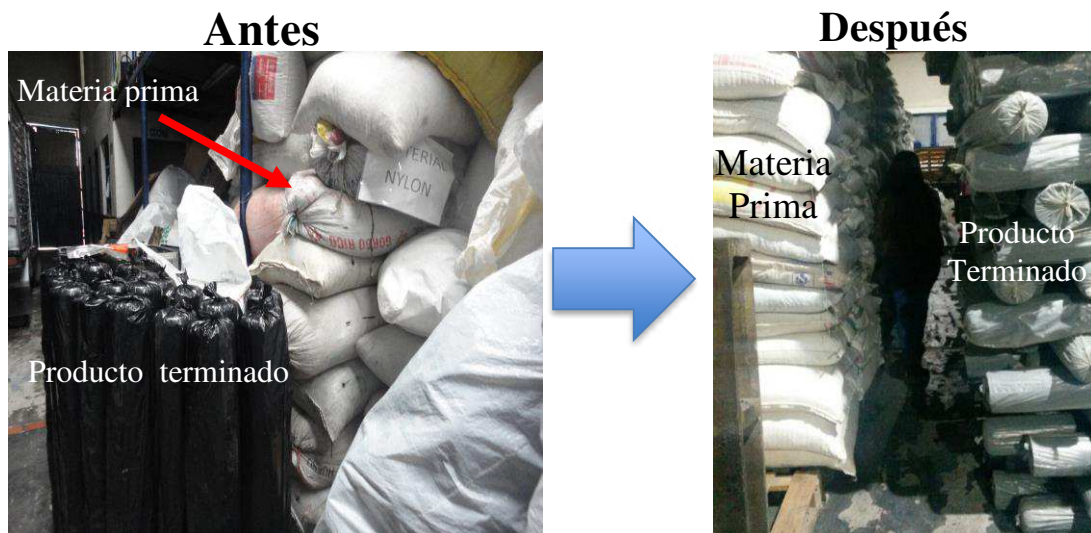
Figura 26. Seiri en la zona de almacenamiento. Nota: Autoría propia.
