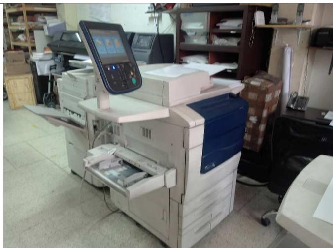
Máquina de impresión digital marca Xerox, esta máquina facilita la impresión de productos en bajas cantidades, impresión de fotografías, etc. Además de esto es utilizada para imprimir las muestras que son entregadas por el cliente.
