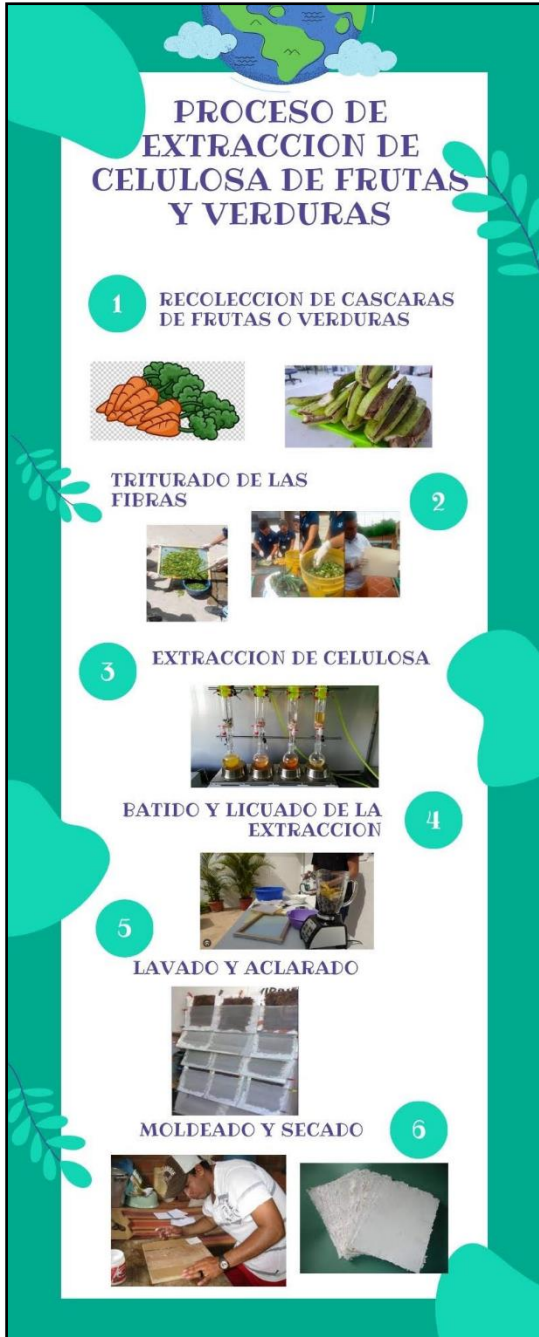
Figura 14. Proceso de extracción de celulosa de frutas y verduras. Diseño de los autores.
