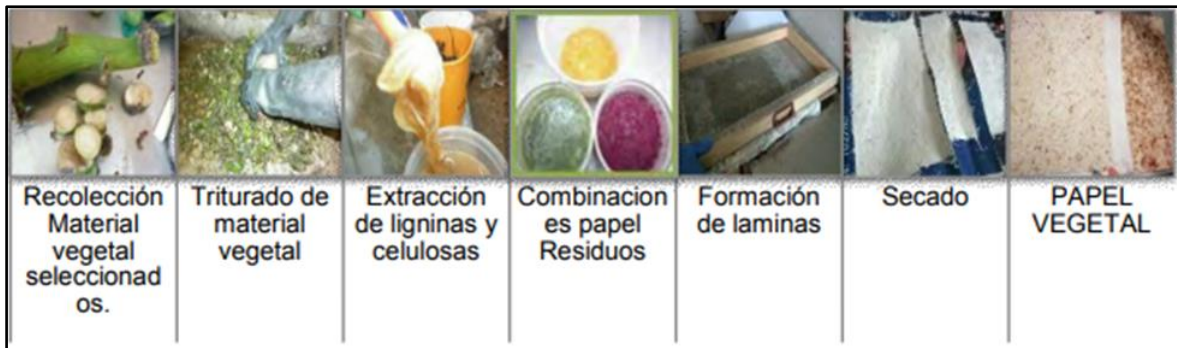
Figura 13. Proceso de elaboración del papel a partir de celulosa. Obtenido de Universidad de Valladolid (2015).
