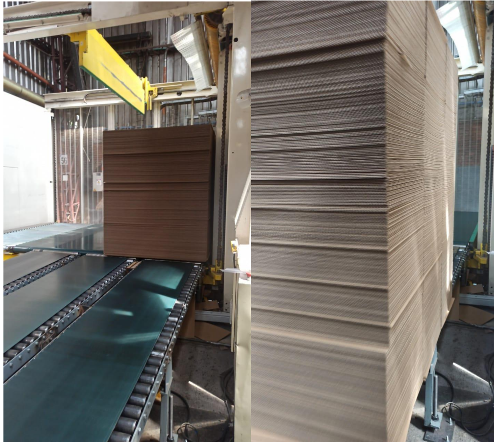
Figura 14. Arrume ideal que sale del corrugador. Nota. Fotografía tomada en las instalaciones de la empresa.
