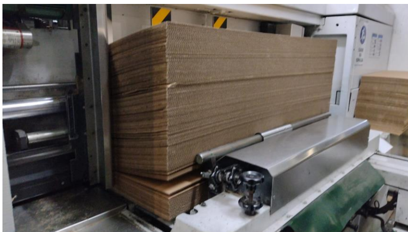
Figura 11. Ingreso de la lámina en la impresora. Nota. Fotografía tomada en las instalaciones
