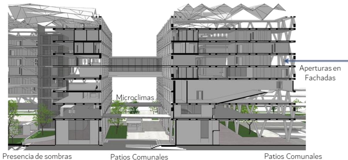
**Figura 24.** Vacíos de ventilación y ganancia solar. Elaboración Propia.
