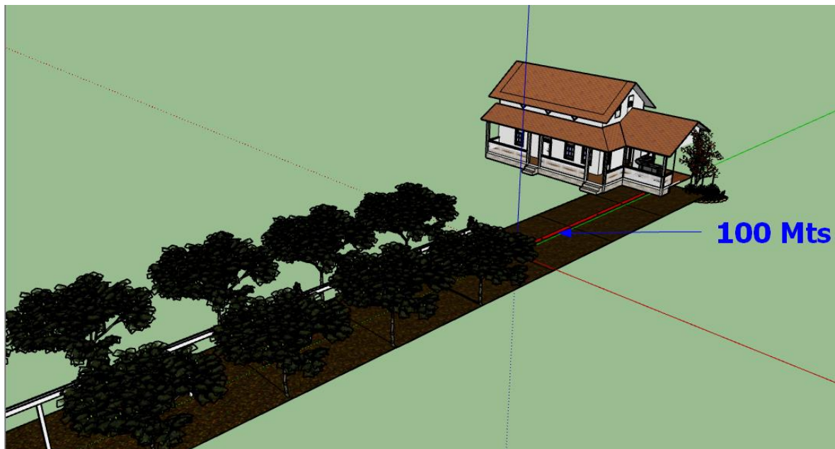
Figura 28. Esquema enlace punto a punto y distancia, perspectiva. (Autoría propia, 2020).
