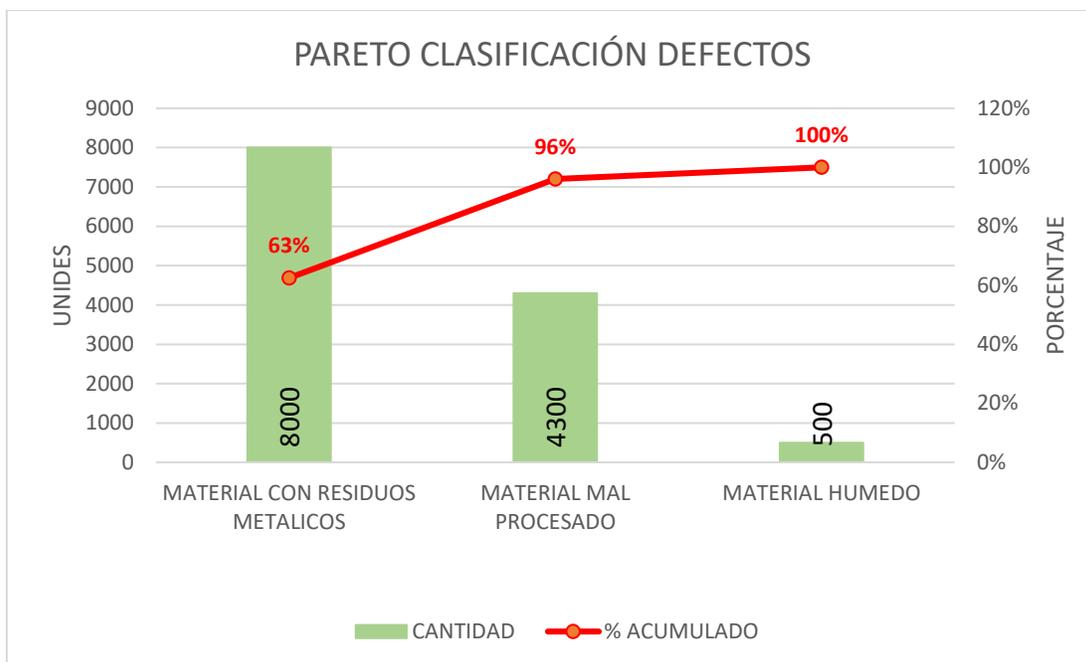
**Figura 14.** Pareto de unidades defectuosas por contaminación con residuos metálicos. (Autoría propia 2019)
