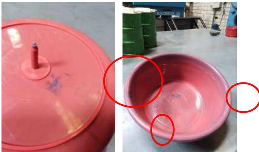
**Figura 9.** Pieza inyectada con defecto de color ( Autoría propia 2019).
