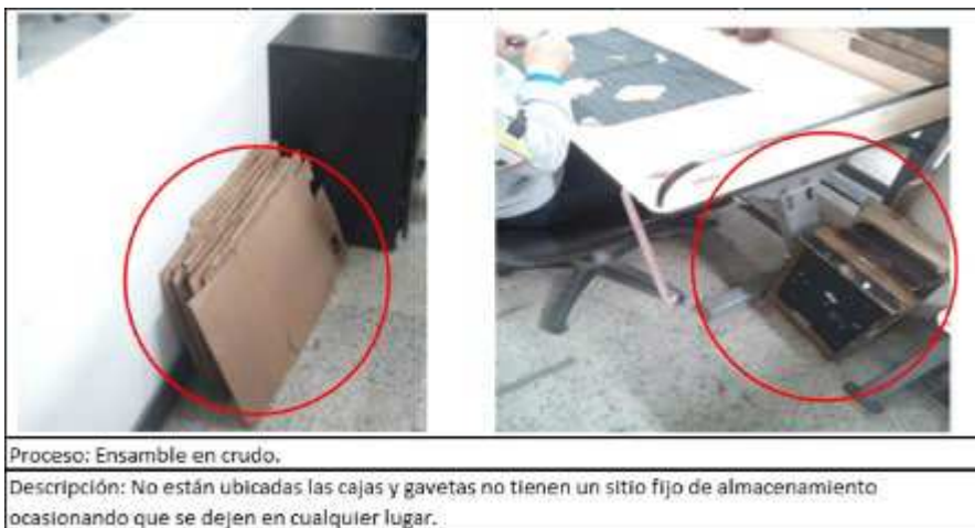
Figura 44. Falta 5s en proceso ensamble en crudo. Autoría propia.
