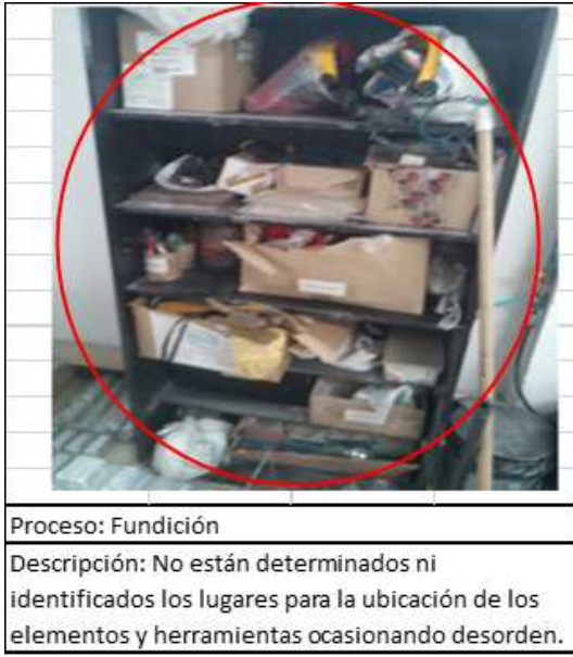
Figura 45. Falta 5s en proceso de fundición. Autoría propia.
