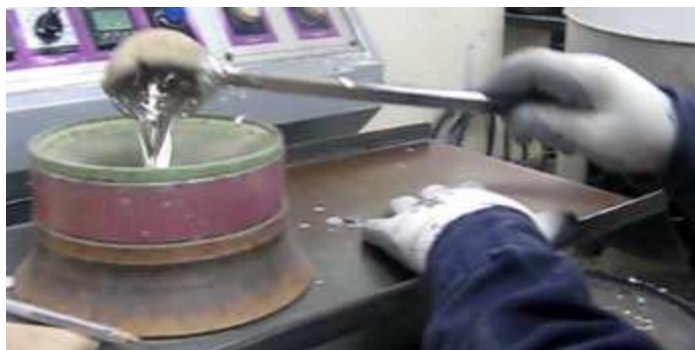
Figura 34. vaciado de material fundido para llenado de moldes. Autoría propia.
