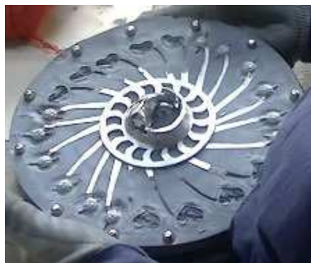
Figura 36. Molde sin cavidades llenas completamente. Autoría propia.
