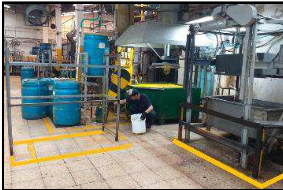
Figura 79 Línea domestica calibre 18, delimitación de espacios de trabajo.
