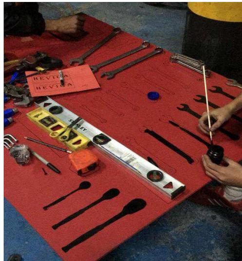
**Figura 66.** Elaboración tablero de herramientas. Elaboración Propia. (2019)
