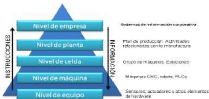
Figura 2. Niveles de automatización según necesidades empresariales. Introducción a la automatización industrial. Ing. Gabriel Zambrano. (2006)
