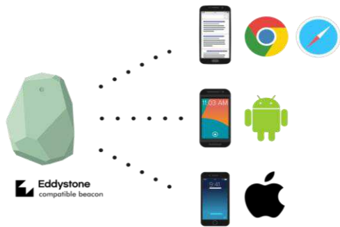
Figura 4. Plataformas compatibles con el protocolo Eddystone de los Beacons de la marca estimote. Estimote (2018).
