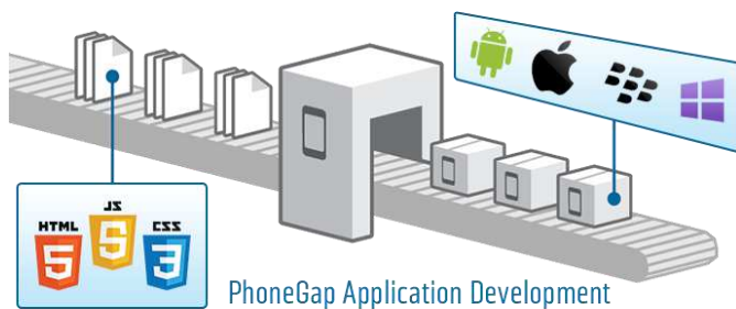
Figura 11. Proceso de compilación de los archivos .HTML. js y .css en Adobe Phonegap para la creación de aplicaciones. Orangemantra (2015).
