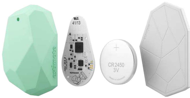
Figura 13. Composición interna y externa de un Beacon de la marca estimote. Medium (2014).
