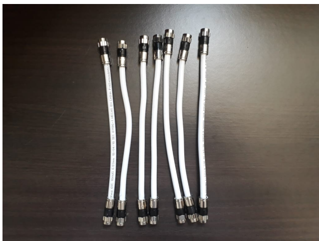
Figura 12 Cables coaxiales de 20 cm ponchados
