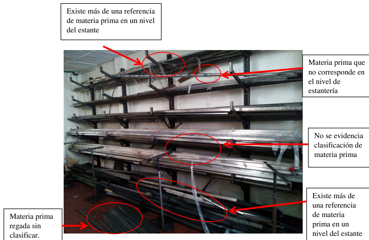
Figura 25. Diagnóstico área de almacenamiento.
