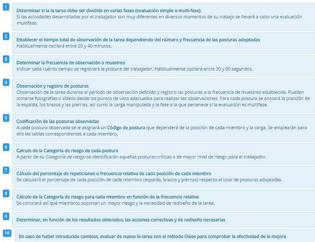
Figura 33. Procedimiento para aplicar el método Owass.
