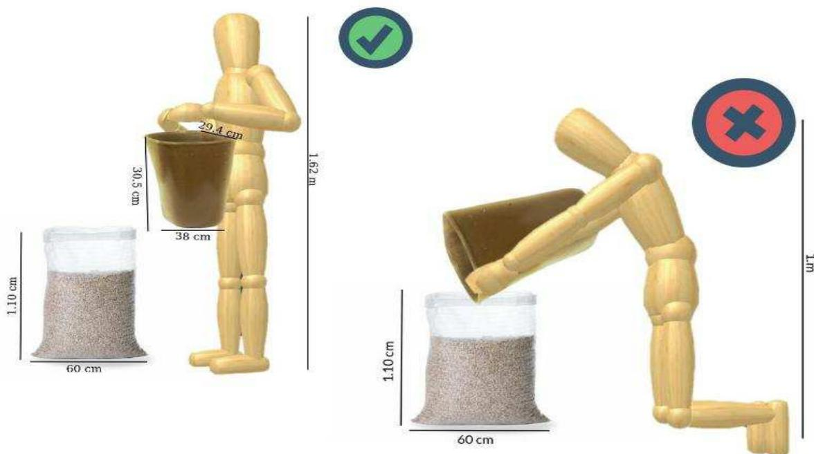
Figura 12. Postura correcta e incorrecta del vaciado del café.
