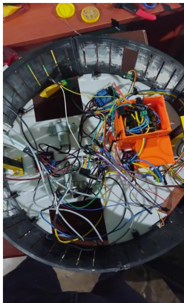
Figura 62. Conexiones prototipo de un robot móvil con identificador de residuos. Autoría propia (2023).
