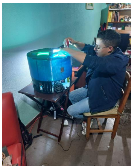
Figura 63. Prueba de indicadores LED. Autoría propia (2023).
