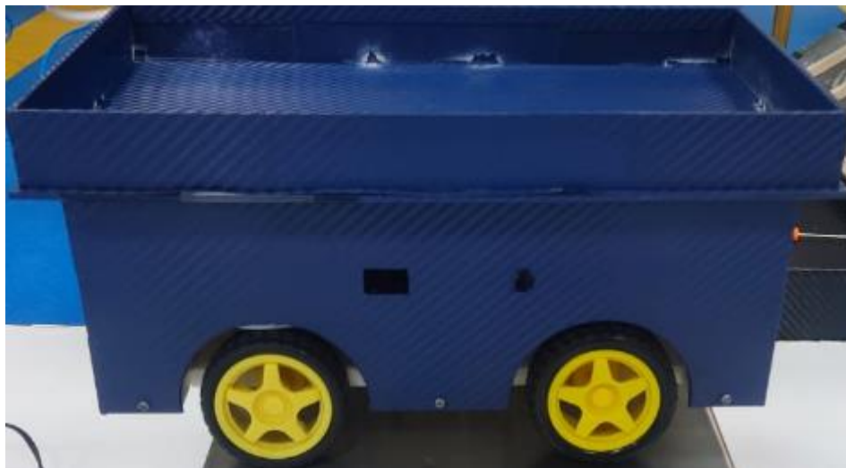
Figura 108. Robot AGV con bandeja de transporte instalada. Elaboración propia (2022).
