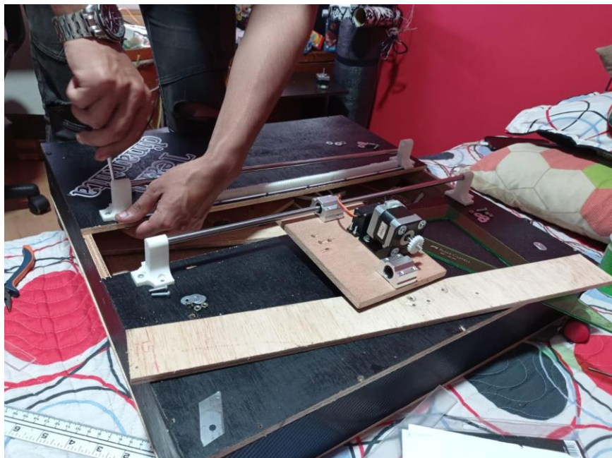
Figura 92. Instalación de rieles a base con cajón. Elaboración propia (2022).
