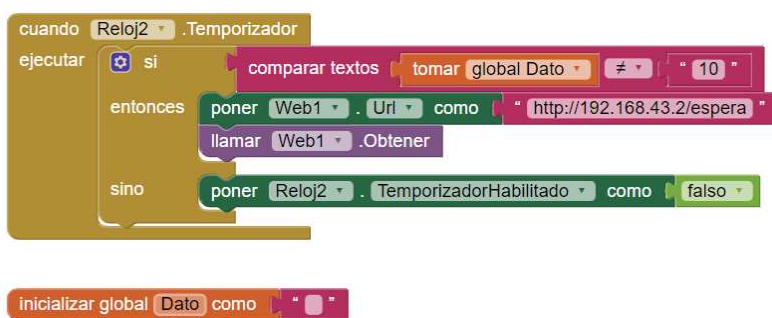
Figura 76. Programación de espera de respuesta del servidor. Elaboración propia (2022).
