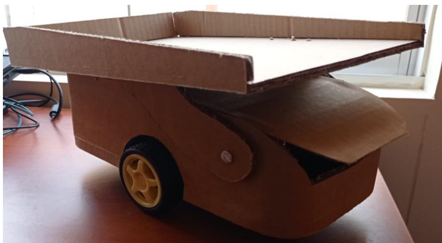
Figura 98. Chasis primer modelo del robot AGV. Elaboración propia (2022).
