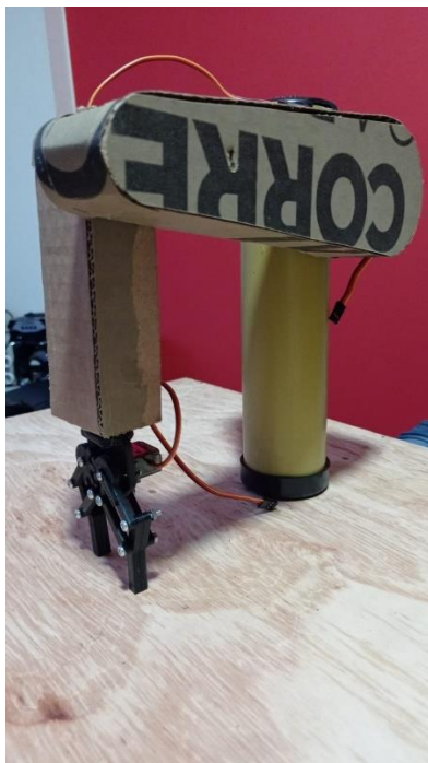
Figura 84. Construcción de brazo robótico con gripper. Elaboración propia (2022).
