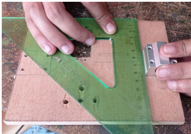
Figura 87. Instalación de rieles para varilla. Elaboración propia (2022).
