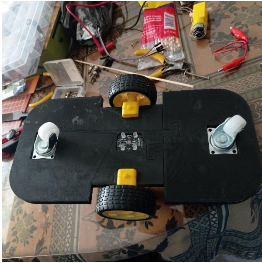
Figura 100. Base construida para el primer modelo del robot AGV. Elaboración propia (2022).
