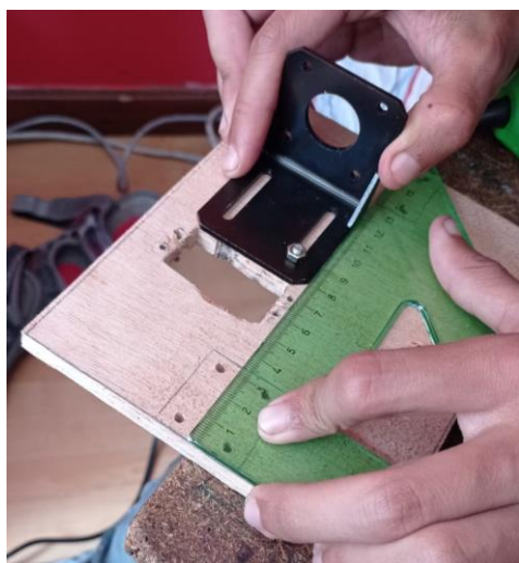
Figura 86. Instalación de soportes para motor paso a paso. Elaboración propia (2022).
