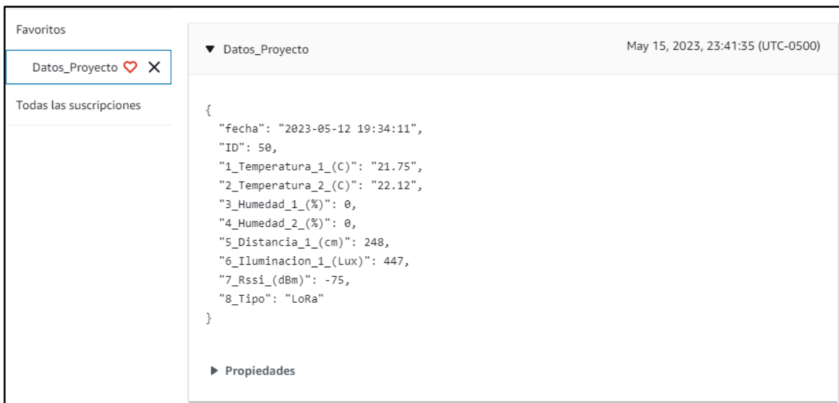
Figura 52. Archivo JSON enviado a la plataforma AWS IoT Core a través del protocolo MQTT(Autoría propia).
