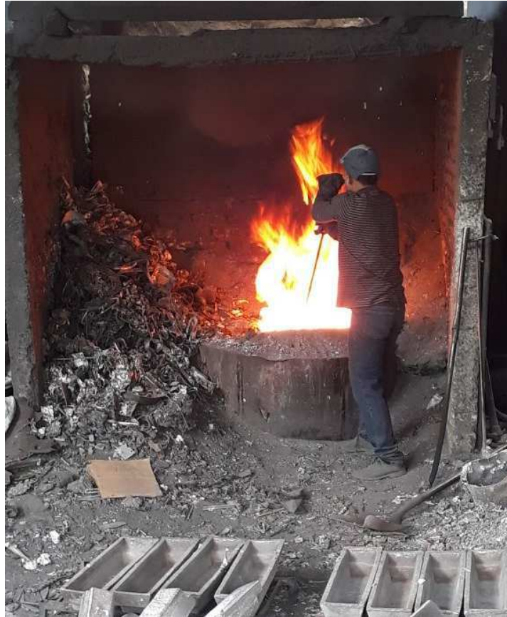
Anexo 11: Alimentación horno de fundición n°1.
