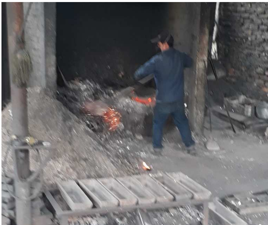
Anexo 14: Extracción de sobrantes de fundición del horno de fundición n°2.
