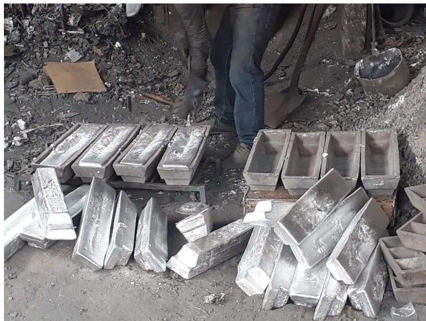
Anexo 13: Extracción de los lingotes de aluminio de las lingoteras.
