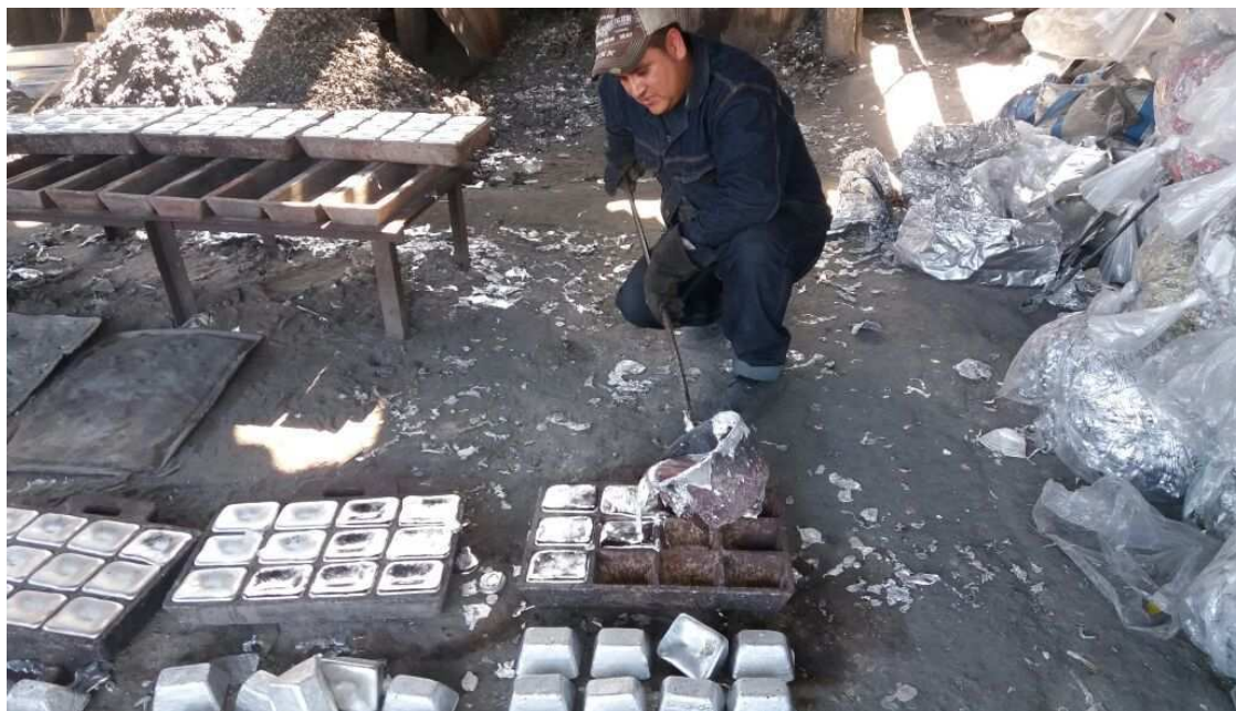
Anexo 3: Alimentación de las lingoteras en área de secado n°2.
