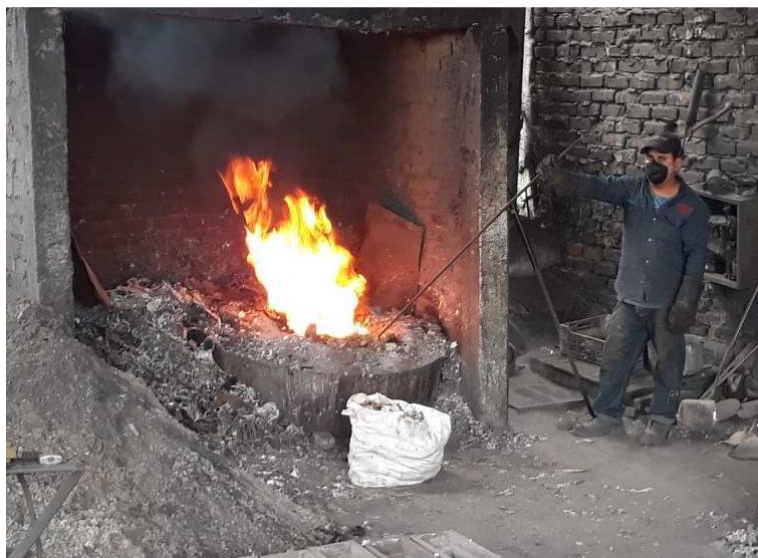
Anexo 12: Alimentación horno de fundición n°2.
