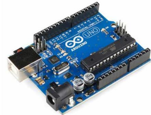
Figura 2. Arduino UNO (Arduino y su documentación en español, s.f.)
