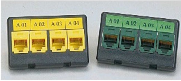
Figura 31. Etiquetado de los puertos del Rack. (CIFP Tartanga, 2023).
