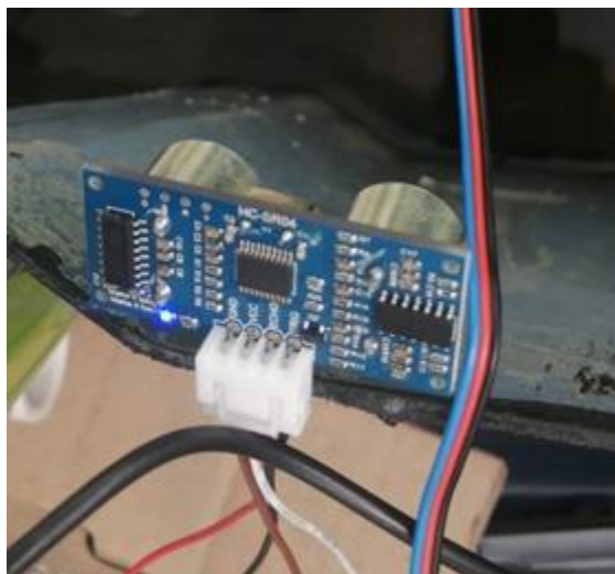
Figura 27. Sensor de nivel del agua. Elaboración propia (2022)
