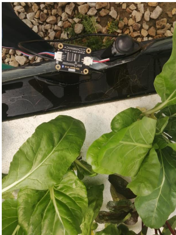
Figura 26. Sensor de conductividad. Elaboración propia (2022)
