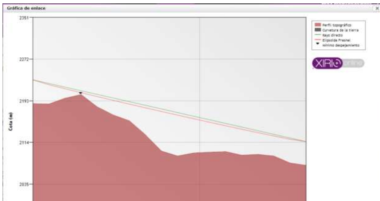
Figura 22. Resultado radio enlace aplicativo web. Elaboración propia.
