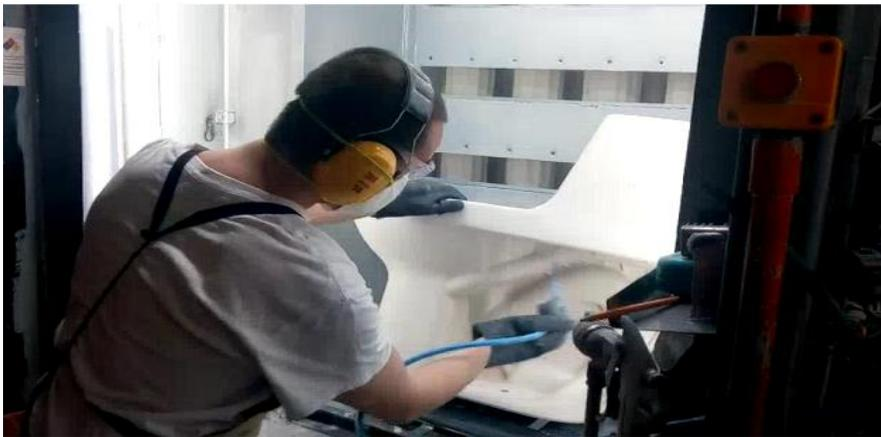
**Figura 24.** Eliminación de los residuos con un compresor de aire. Moldes OP Smart. Corona Planta Madrid (2020).
