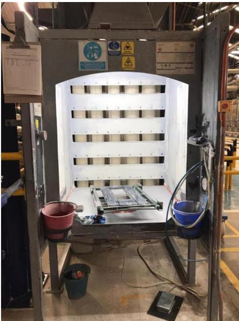
**Figura 26.** Cabina de pulido en seco. Corona Planta Madrid (2020).
