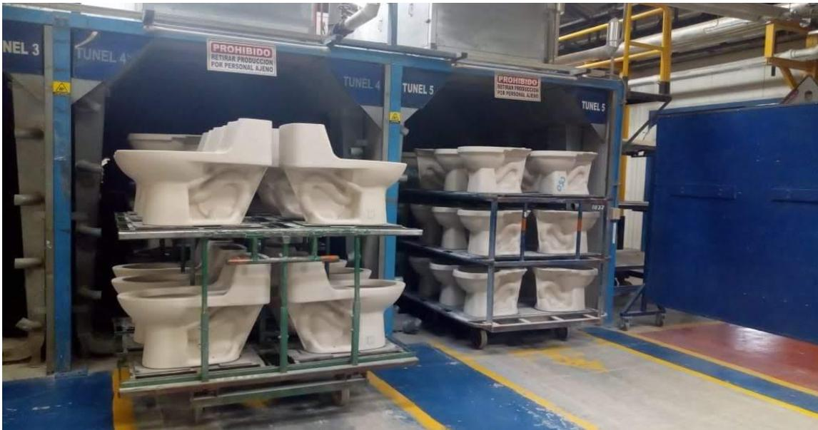
**Figura 13.** Moldes sanitario OP Smart ingresando al proceso de secado. Elaboración propia (2019).
