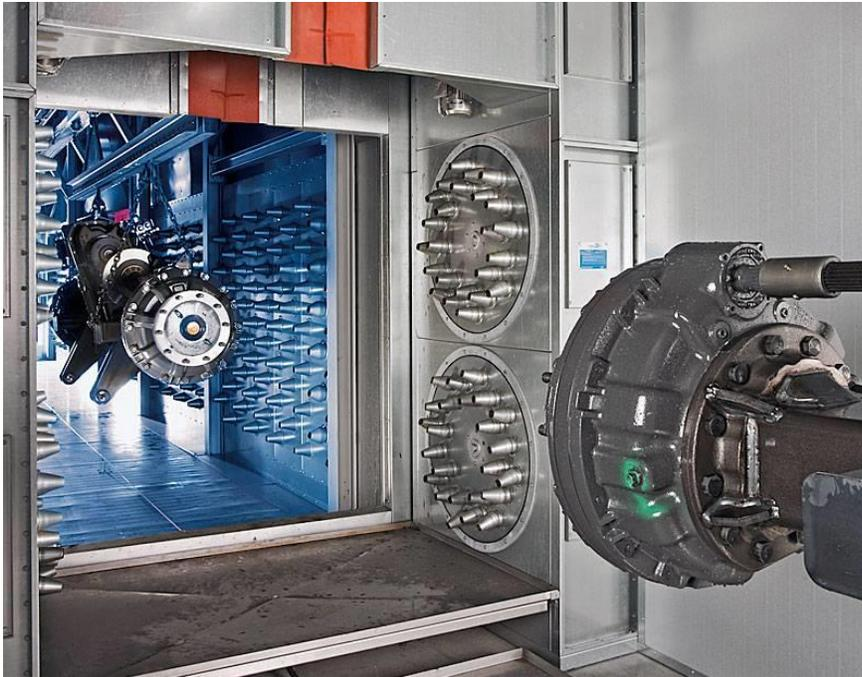
**Figura 28.** Dispositivo automático de soplado rotativo. Elaborado por Rippert (2020)
