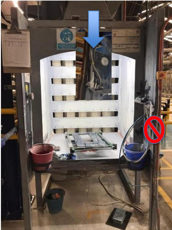
**Figura 30.** Cabina de pulido en seco. Corona planta Madrid. Elaboración propia (2020).
