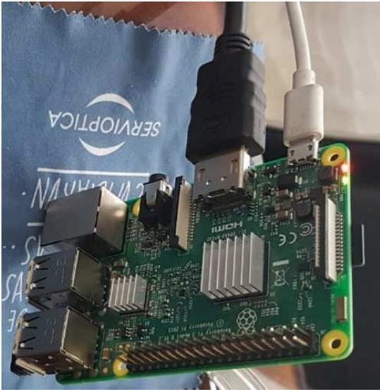
Figura 2. Raspberry pi 3 con alimentación HDMI y corriente. (Autoridad propia)
