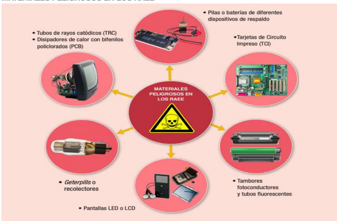
Figura 8. Materiales peligrosos en los RAEE. SEMARNAT (2018) .
