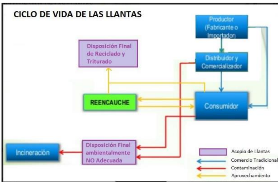
Figura 7. Ciclo de vida de una llanta. Llanos Pomaleque J.F. y Zubilaga N P, 2016. Página 18.
