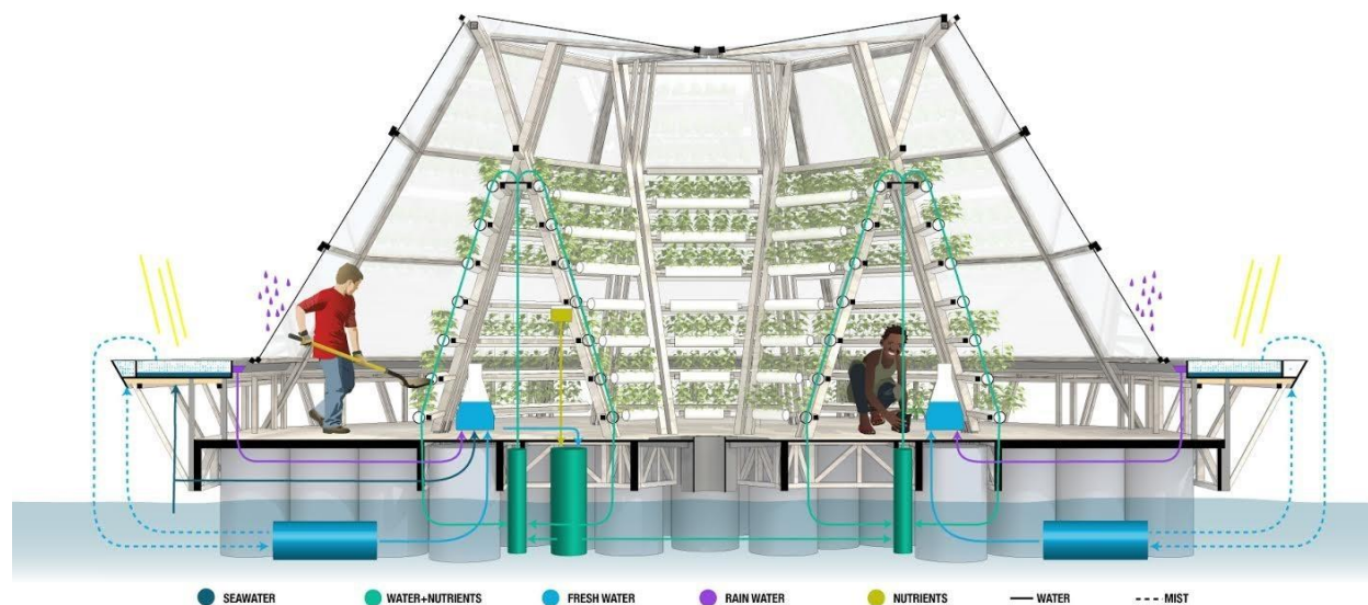
Figura 2. Sistema de reutilización de aguas. Walker (2014).
