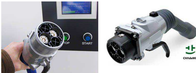
Figura 42. Conector CHAdeMO. wallbox (2019).
