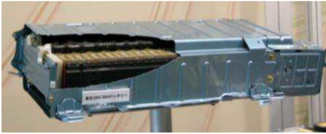
Figura 34. Batería NiMH. ( fundación energetica de la comunidad de madrid, 2015 )
