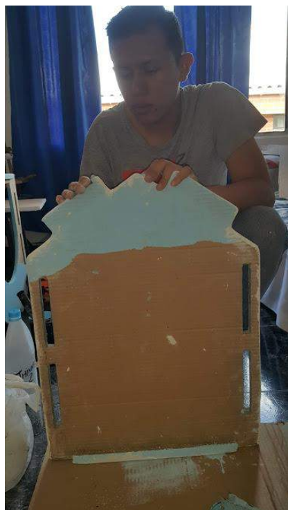
Figura 89. Proceso de lijado de los bordes. Elaboración propia.
