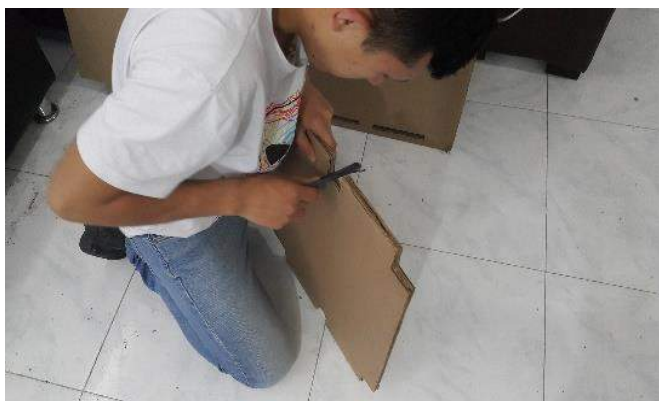
Figura 62. Proceso de lijado a láminas. Elaboración propia.
