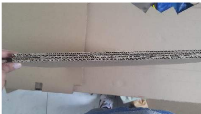
Figura 60. Lamina pegada. Elaboración propia.
