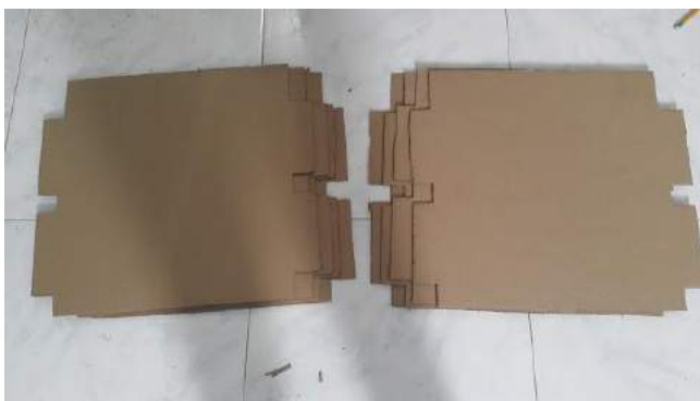
Figura 56. Láminas laterales cortadas. Elaboración propia.
