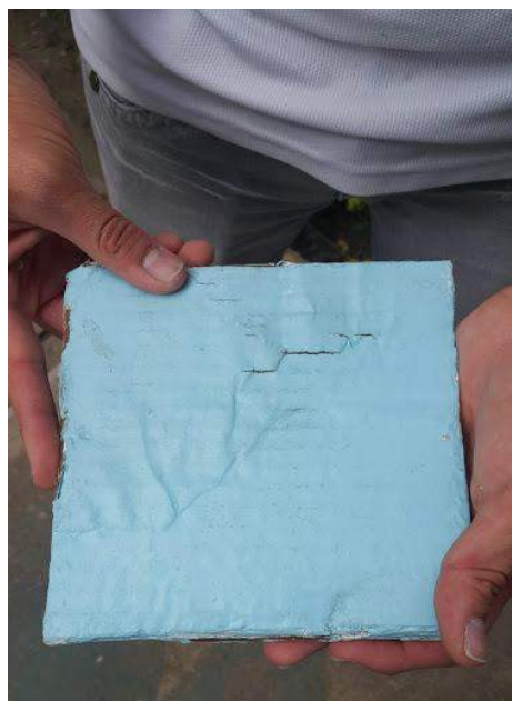
Figura 103. Pieza después de haber sido golpeada con el mazo. Elaboración propia.
