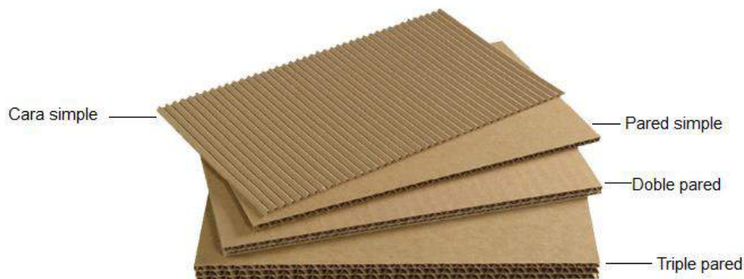
Figura 41. Tipos de cartón corrugado. Cartonlab (s.f).
