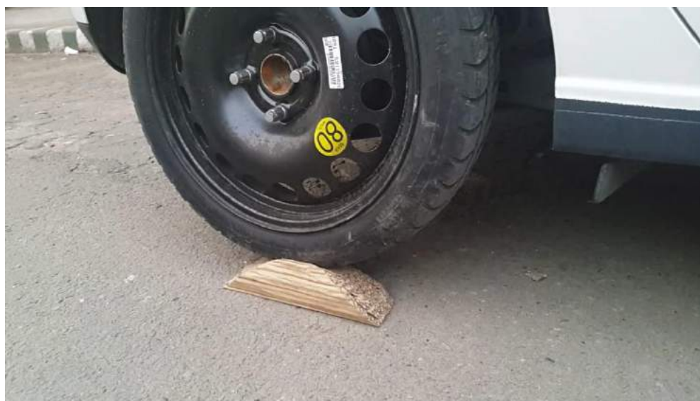
Figura 114. Rueda del automóvil sobre la pieza de prueba de 20 x 10 cm. Elaboración propia.
