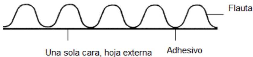
Figura 42. Componentes del cartón corrugado de cara simple. Empaques de Colon S.A (s.f).
