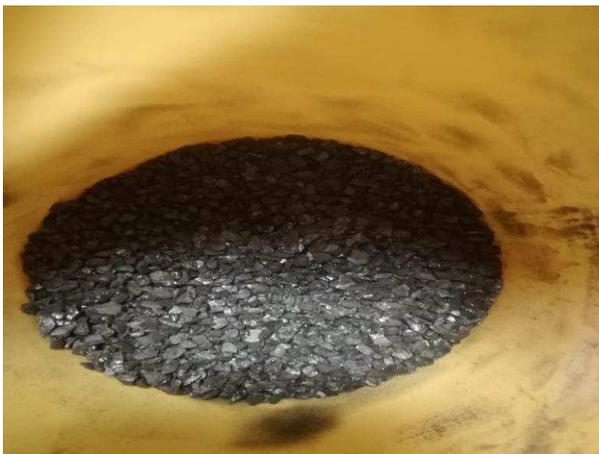
**Figura 76.** Fase 5, carbón activo espesor 5cm. (Elaboración propia).
