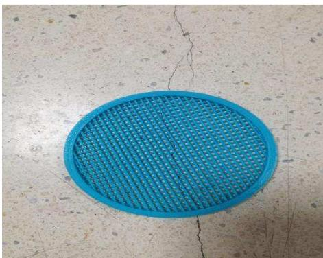
**Figura 61.** Rejilla para separación de fases de 5mm de grosor con un radio de 5.08cm y una cuadrícula de 2mm x 2mm. (Elaboración propia).
