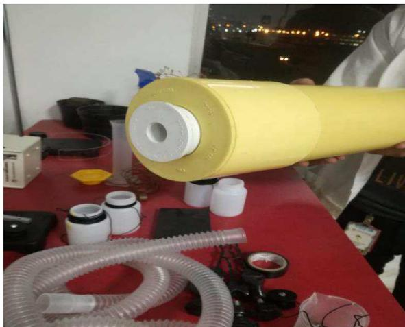
**Figura 66.** Ensamble componente de salida de caudal con el componente de procesamiento por medio de la unión de 4" con una salida de ½". (Elaboración propia).
