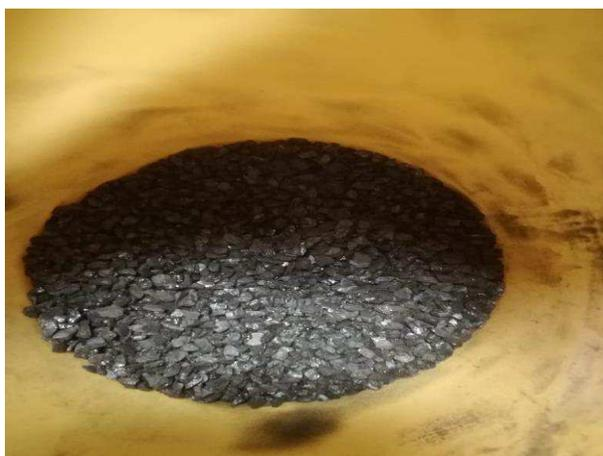
**Figura 69.** Fase 1 carbón activo espesor 5cm. (Elaboración propia)
