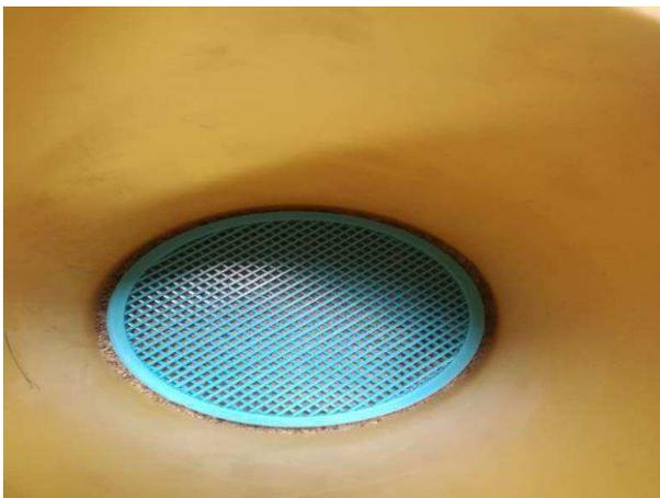
**Figura 77.** Fase 6, arena de río 70/70, espesor 5cm. (Elaboración propia).
