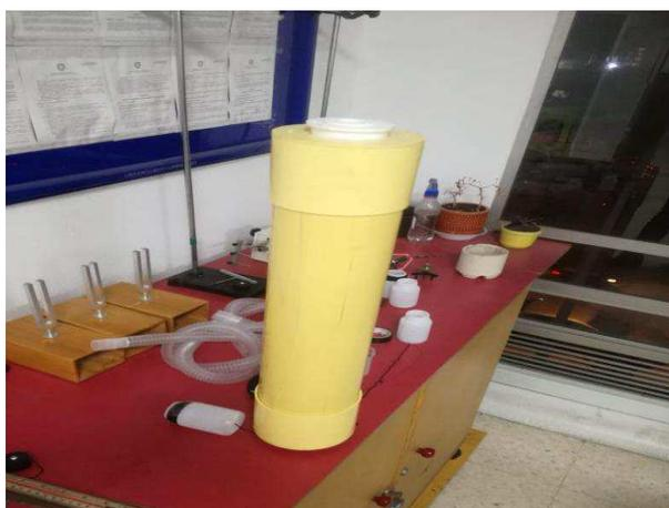
**Figura 67.** Ensamble componente de entrada de caudal con el componente de procesamiento por medio de la unión de 4" con una entrada de 1" y sistemas de rosca para mantenimiento. (Elaboración propia).
