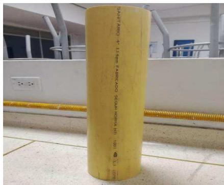
**Figura 63.** Tubo de 4" de 55cm de largo que funciona como el espacio de transición de las fases. (Elaboración propia).
