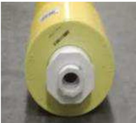
**Figura 64.** Pieza de ingreso de agua a procesar con un caudal de 1". (Elaboración propia).
