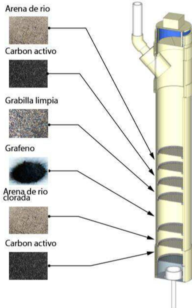
**Figura 91.** Diseño de relación entre producto y fases de filtrado. (Elaboración propia) elaboración software de diseño y modelado SketchUp.
