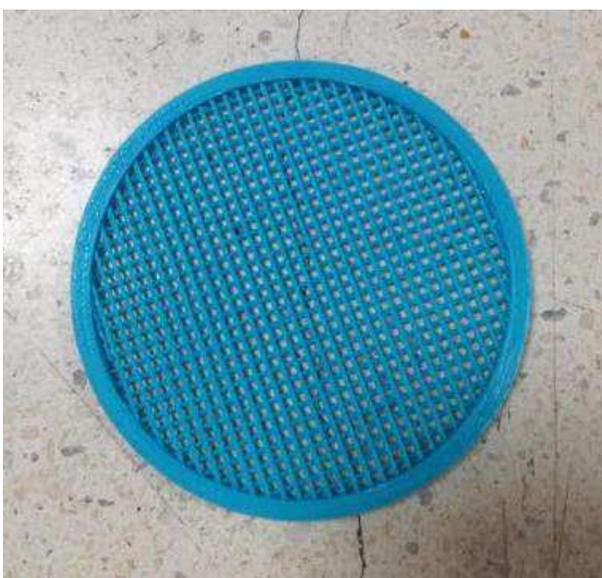
**Figura 50.** Rejilla prototipo de separación entre procesos impresa en 3D. (Elaboración propia)
