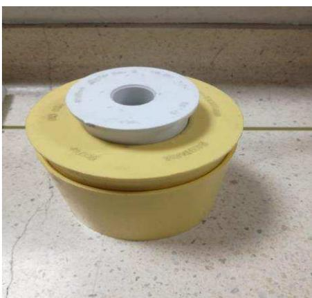
**Figura 65.** Pieza de salida o de final de proceso con salida de un caudal de ½". (Elaboración propia).
